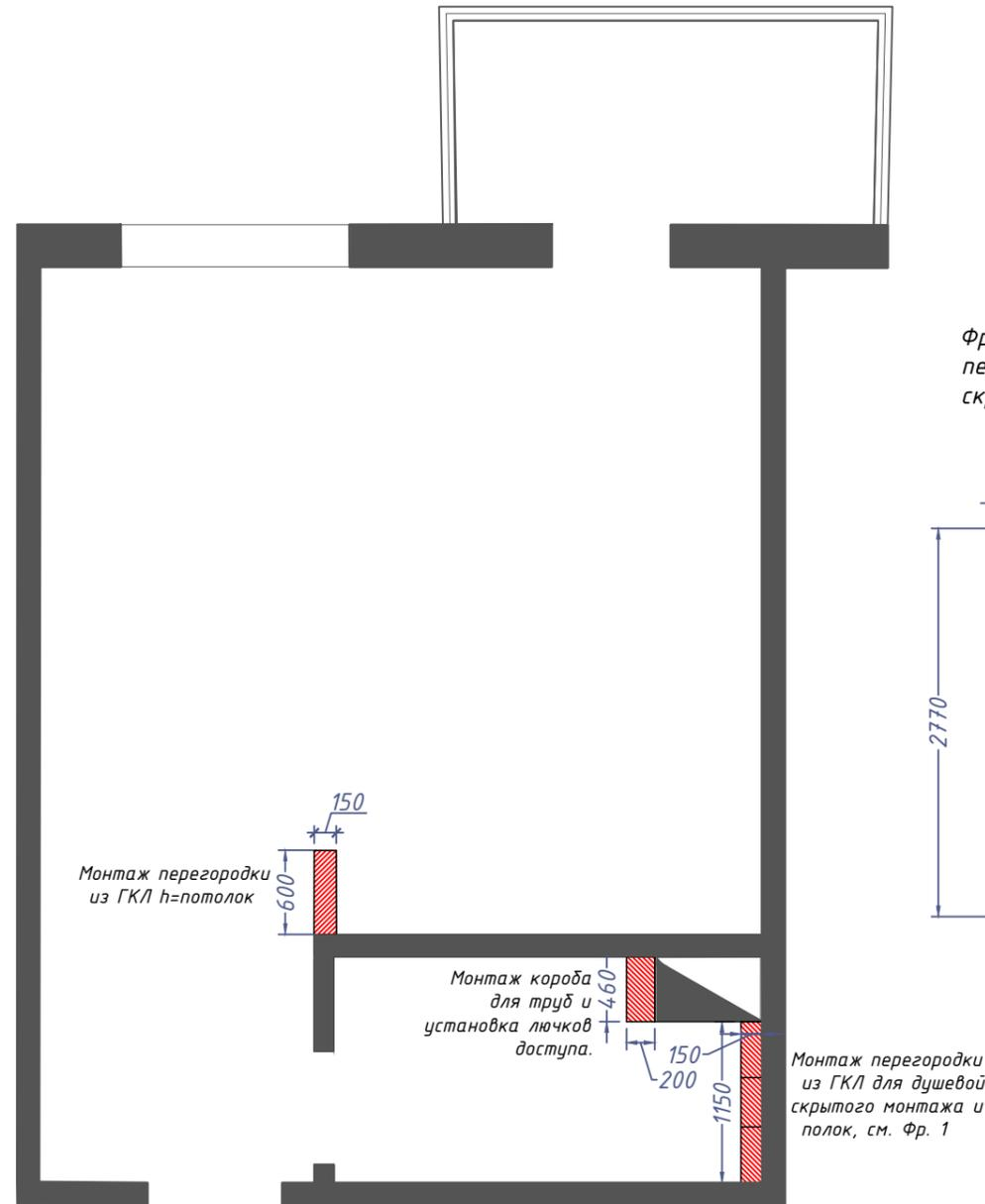
Фрагмент 1. Монтаж перегородки для душа скрытого монтажа и полок
